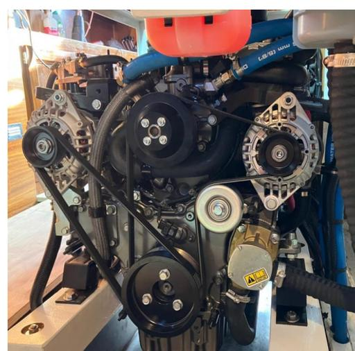
Que d'efforts pour installer le nouveau moteur et le raccorder à son environnement mécanique (inverseur, arbre de transmission), hydraulique (circuits d'eau de refroidissement, chauffe eau) et électrique !
