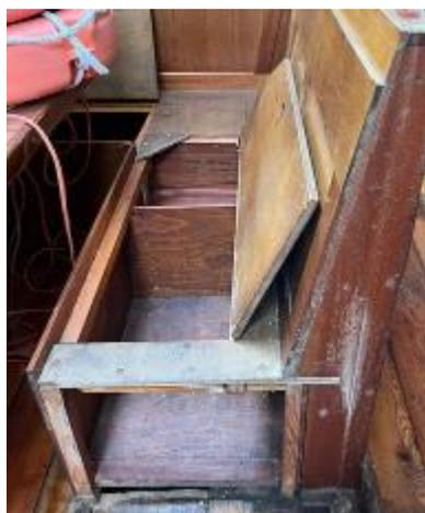
Pour accéder au moteur et à l'arbre de transmission il a fallu, entre autres, démonter la banquette du carré et les cloisons séparant le couloir et le carré de la cabine centrale.
