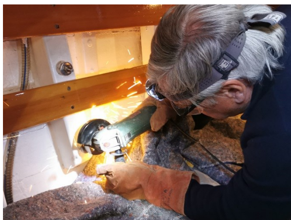
Meulage des boulons des cadènes
