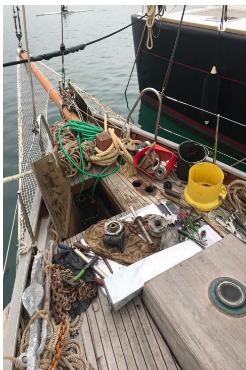
Réparation du guindeau
